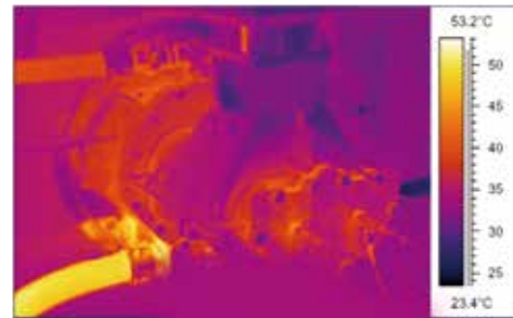
Aumento de temperatura limitada de solo 25 °C dentro del compresor
